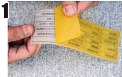
裏側の黄色いフィルムを剥がします。粘着ゲル層にはできるだけ触れないでください。
