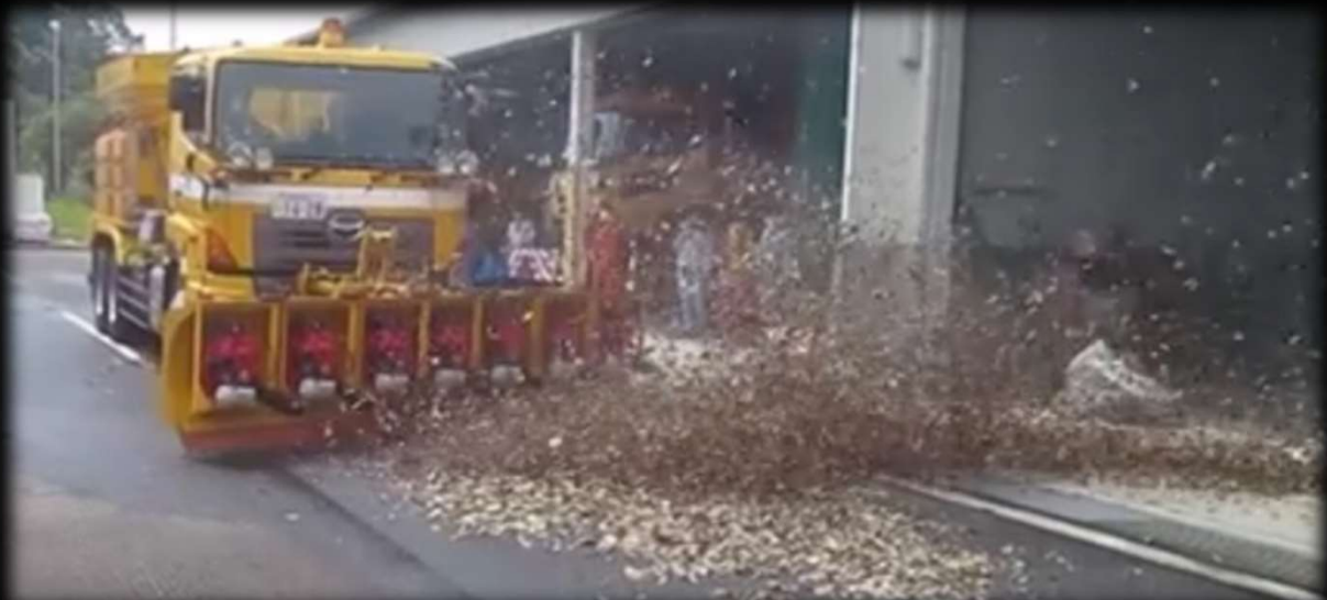
濡れ落ち葉の排除状況（作業速度：約10 Km/h）
