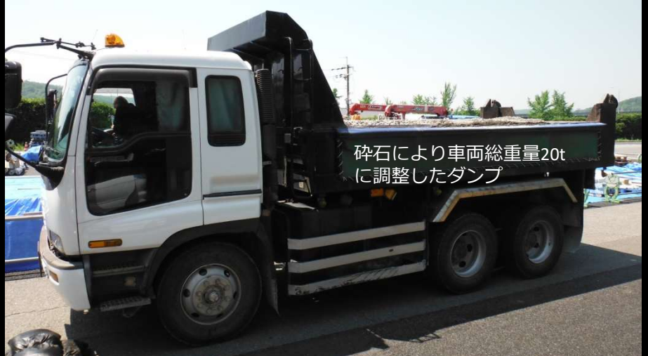
試験車両 (車両総重量20t 3軸ダンプ) 土のう (25Kg、豊浦産標準砂)
